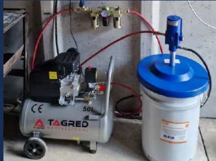
Centrálny mazací systém s pneumatickým čerpadlom
